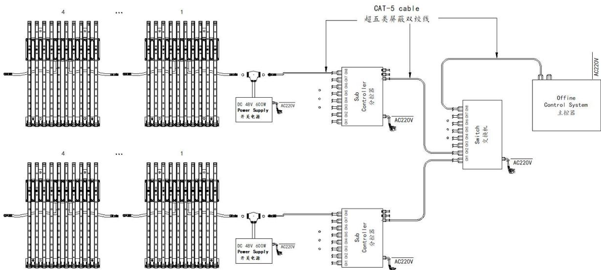
说明: 600W开关电源, 供电回路可带4个120W模组;
