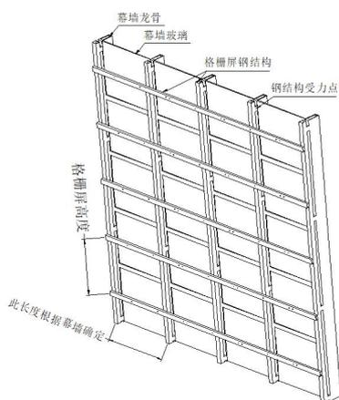
2. 固定型材安装件,用 M8 螺丝和螺母固定型材安装件在钢结构上
